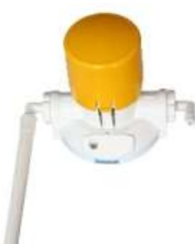
Ручной химический насос-дозатор DPL.03 предназначен для перекачки и дозирования реагентов. Устанавливается на стену. Работает путём нажатия на жёлтую крышку (одно нажатие = одна доза, доза регулируется).
